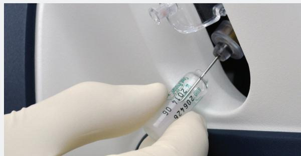
Proben aus Ringversuchampullen zur Qualitätskontrolle können ohne zusätzlichen Adapter entnommen werden.
