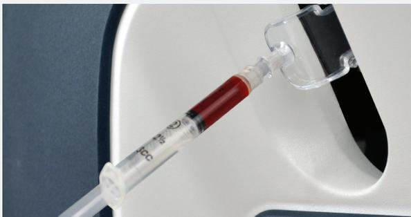
Spritzen können zur automatischen Probenentnahme auf einen Luer-Anschluss aufgesteckt werden.
