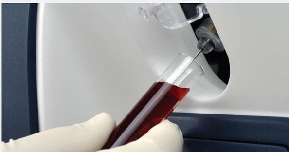
Proben können direkt aus Röhrchen angesaugt werden. Eine Übertragung der Probe auf eine Spritze oder ein Kapillarröhrchen ist nicht erforderlich.
